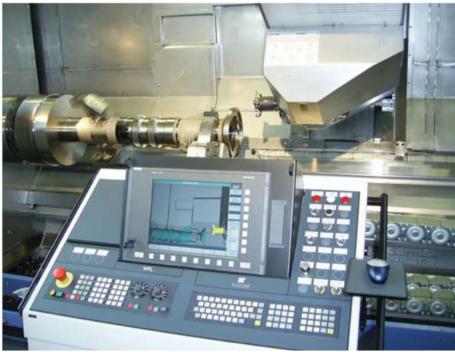
Rys. 6. Przykład symulacji pracy obrabiarki CNC w panelu sterowania CNC
