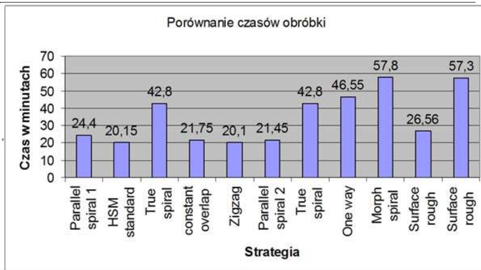
Rys. 1 Porównanie czasu realizacji różnych strategii obróbki zgrubnej tej samej części typu matryca, tym samym narzędziem, z takimi samymi parametrami obróbki. [1]
