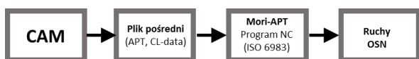
rys. 3 Uniwersalny program dostarczony z obrabiarką (Mori-APT) programuje obróbkę na podstawie pliku pośredniego.
